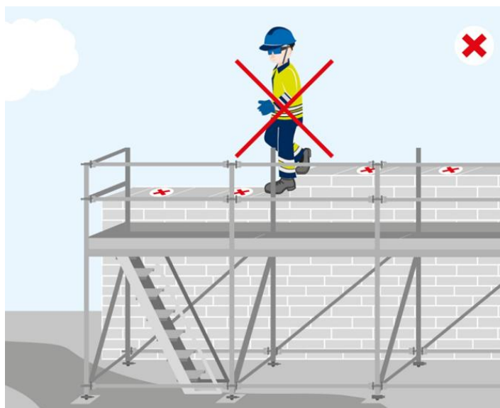
Rysunek 12 Zakaz chodzenia po konstrukcjach murowych
