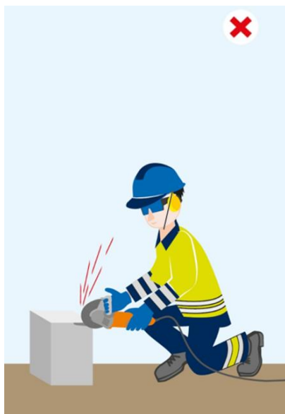
Rysunek 13 Zakaz cięcia nieprzymocowanych cegiet i pustaków
