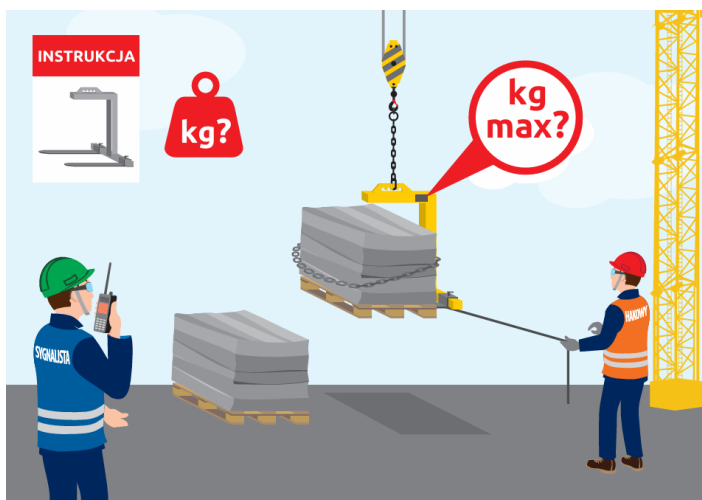
Rysunek 1 Zastosowanie uchwytu widłowego do transportu pustaków, cegieł, zaprawy na paletach
