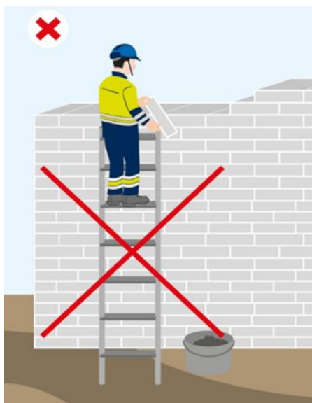
Rysunek 11 Zakaz wykonywania robót murarskich i tynkarskich z drabin
